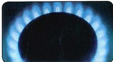
La giusta taratura del regolatore di pressione permette un flusso di gas efficiente. Un cattivo funzionamento del sistema regolatore di pressione /bruciatore potrebbe dar origine ad una fiamma rossa e fumosa o una fiamma che si spegne.
